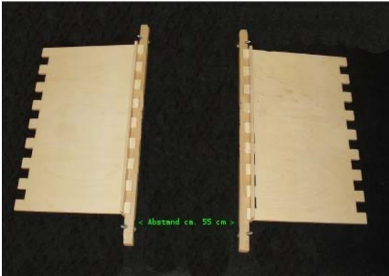
Das Regal-Element mit dem Stellfuß ( A 5 ) mittig auf die Fußteile ( B 1 ) mit den gezinkten Ablageflächen-Teilen ( C 1 ) stellen.
